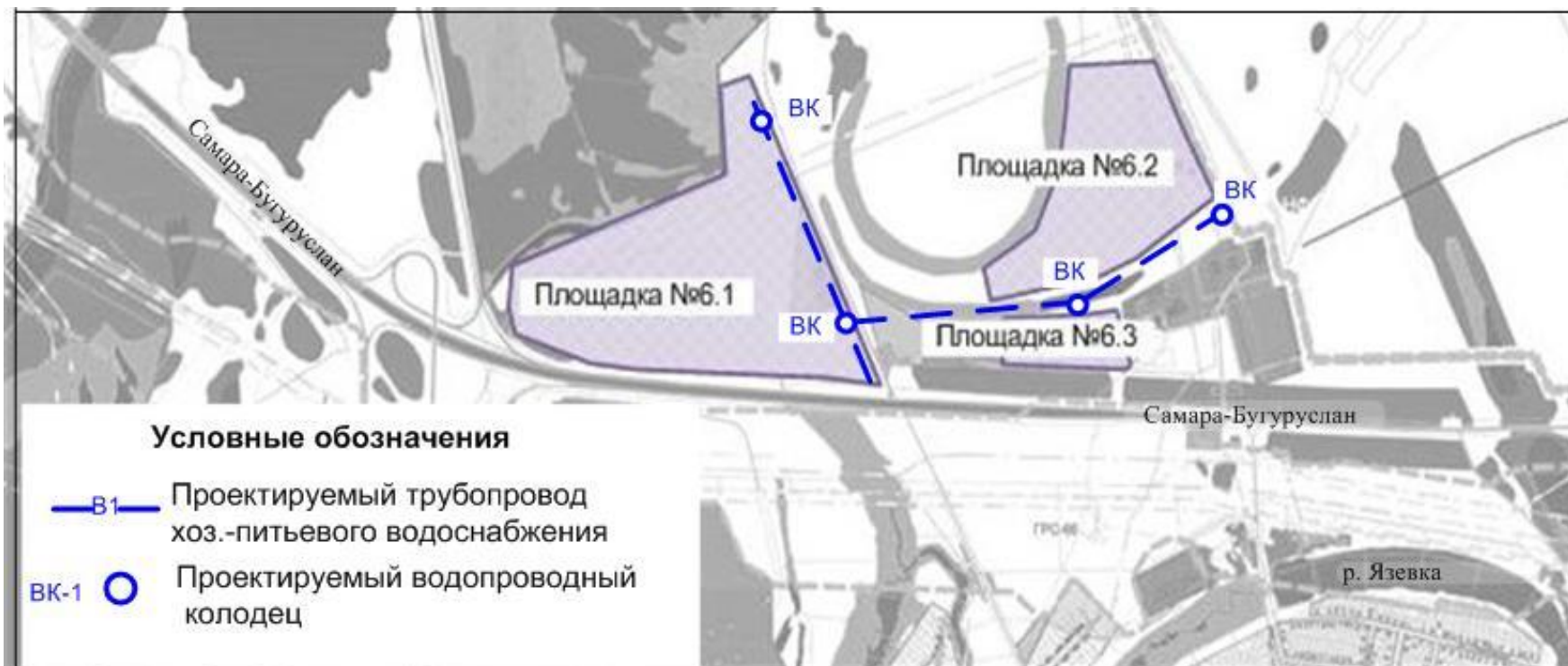
Рисунок 2.4.9.6 – Схема размещения планируемых объектов централизованной системы водоснабжения на территории северо-западной части г. Кинель перспективного строительства под жилую зону
