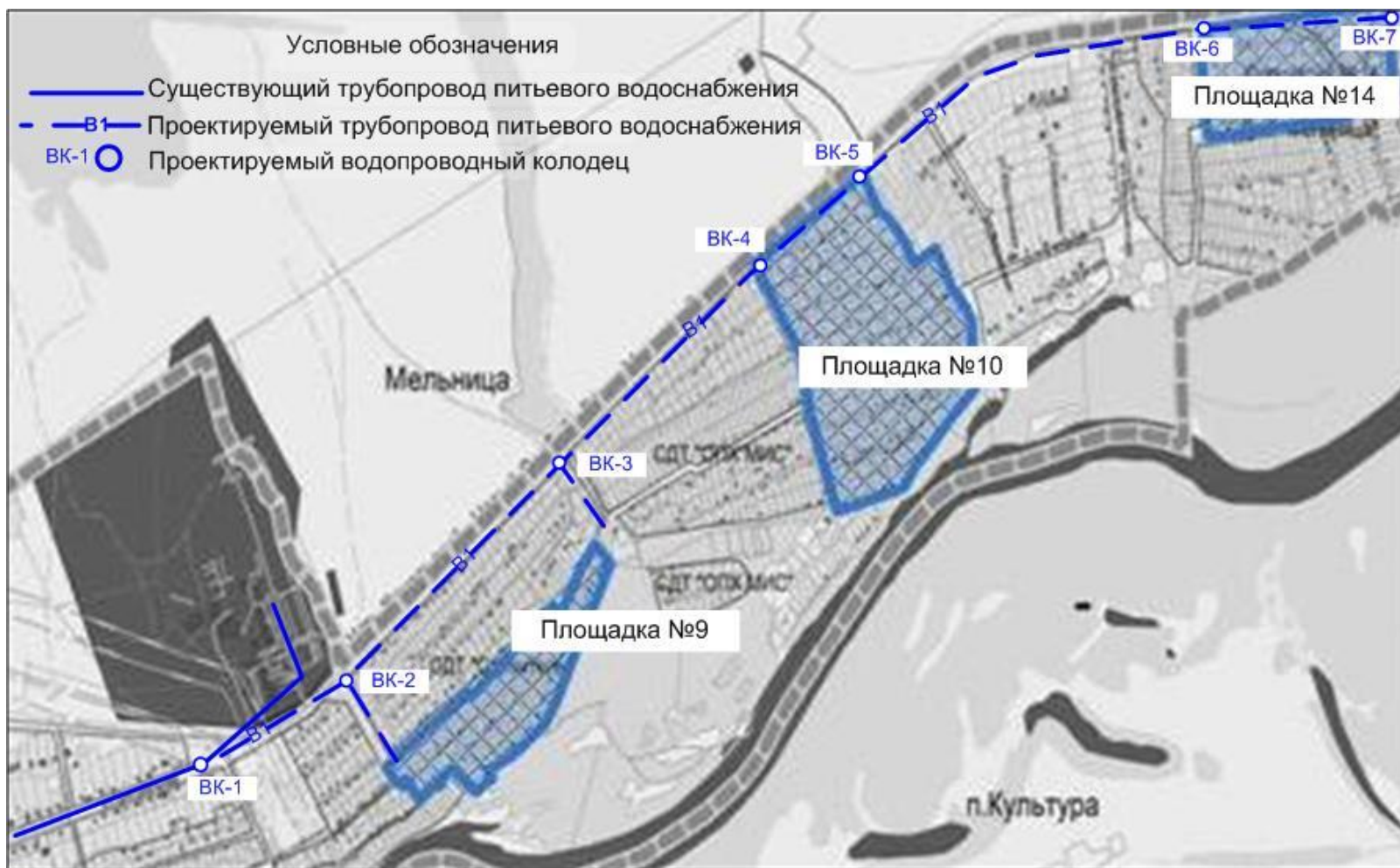
Рисунок 2.4.9.1 – Схема размещения планируемых объектов централизованной системы водоснабжения на территории п.г.т. Усть-Кинельский площадок № 9, 10, 14 перспективного строительства под жилую зону
