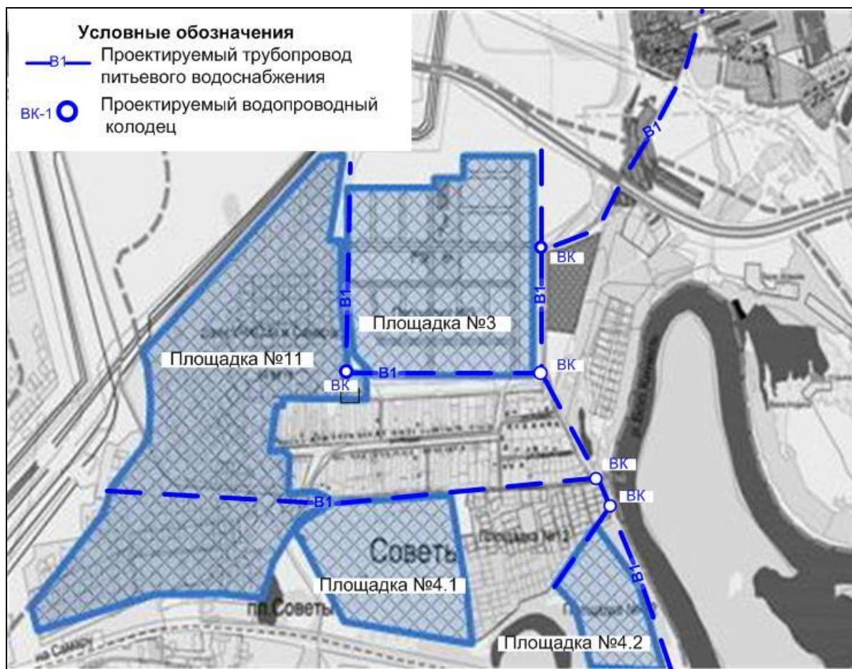
Рисунок 2.4.9.4 – Схема размещения планируемых объектов централизованной системы водоснабжения на территории п.г.т. Усть-Кинельский площадок № 3, 11, перспективного строительства под жилую зону в районе п. Советы
