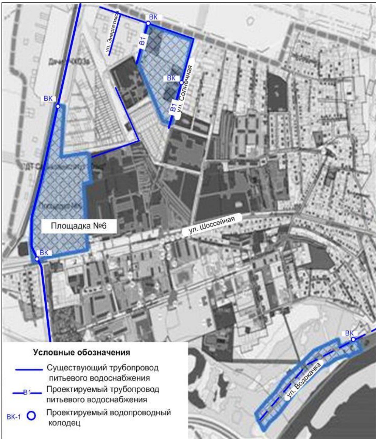
Рисунок 2.4.9.3 – Схема размещения планируемых объектов централизованной системы водоснабжения на территории п.г.т. Усть-Кинельский площадки № 6 перспективного строительства под жилую зону
