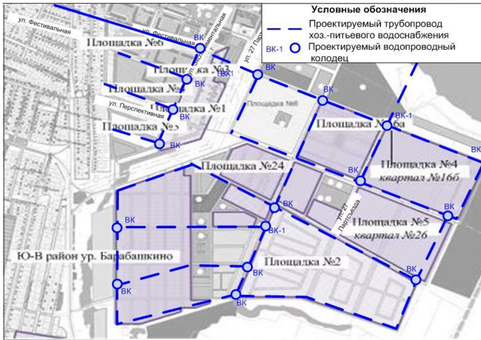
Рисунок 2.4.9.9 – Схема размещения планируемых объектов централизованной системы водоснабжения в юго-восточном районе г. Кинель перспективного строительства под жилую зону
